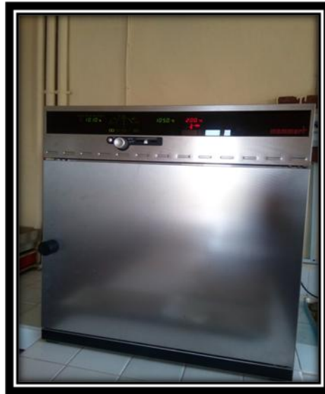
Figure 12 : Etuve de type MEMMERT utilisée lors de notre étude (Photo prise par Farsi et Mohamed benatia 2018)
