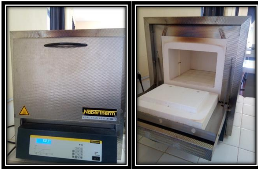
Figure 13: Four à moufle utilisée lors de notre étude (Photo prise par Farsi et Mohamed banatia , 2018).
