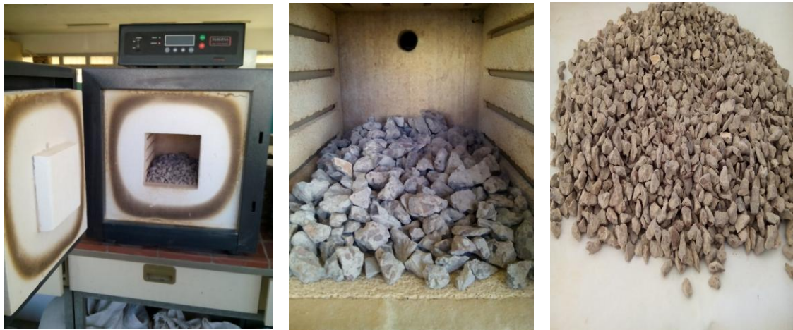
Figure II. 22: Traitement thermique des granulats recyclés.
