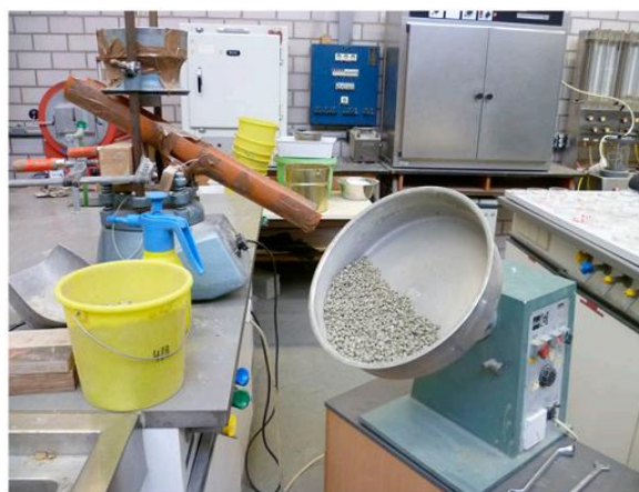
Figure I. 35 : Tambour rotatif où l'encapsulation de l'agrégat recyclé a eu lieu [130].
