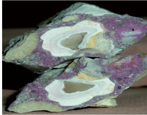
Figure I. 23: Influence du carbonation sur le béton de graviers recyclés [92].
