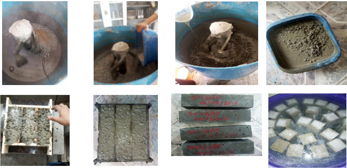
Figure II. 11 : Préparation des éprouvettes du béton.
