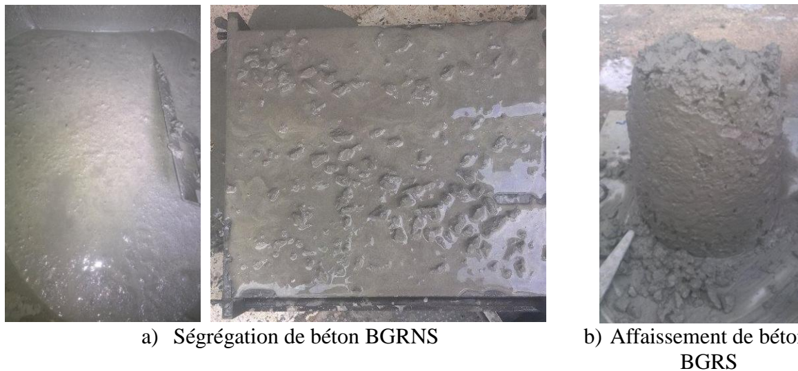
Figure III. 3 : Apparence des bétons à l'état frais
