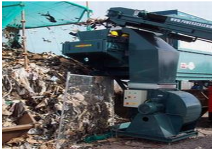
Figure I. 7 : Eliminateur des matériaux légers par jet air
