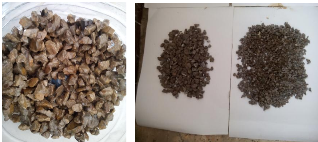
Figure II. 24 : Traitement par résine
