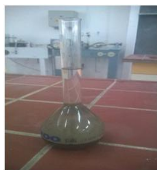
Figure II. 16 : La masse volumique du ciment avec benzène
