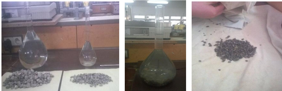
Figure II. 19 : Le mode opératoire de l'essai d'absorption d'eau par la méthode de chiffon
