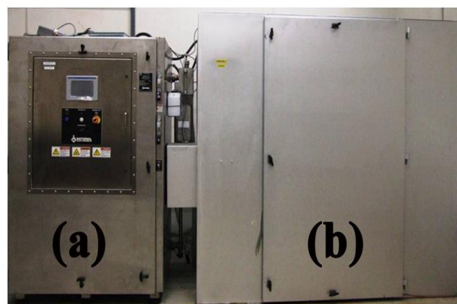
Figure I. 31 : Le système de battage par micro-ondes ; (a) unité génératrice de micro-ondes (b) chambre de bénéfice GBR [125].
