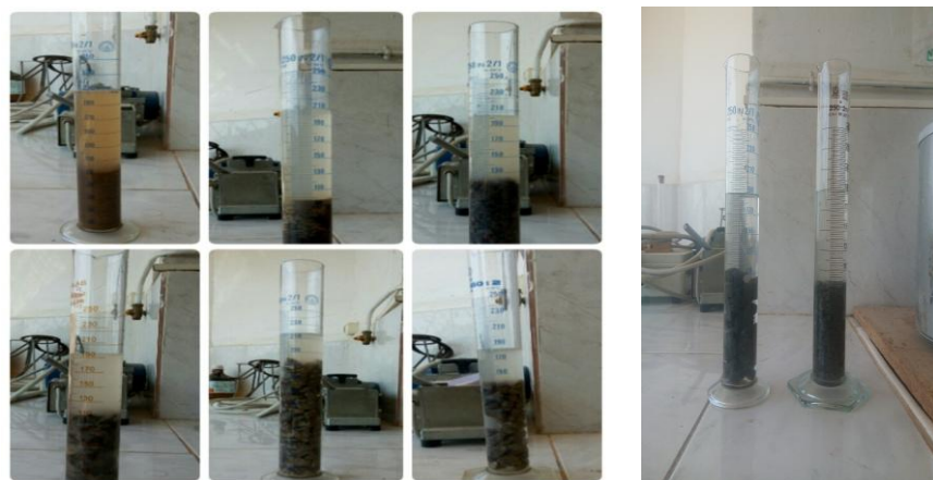
Figure II. 15 : Les masses volumiques absolues à l'aide d'une éprouvette graduée
