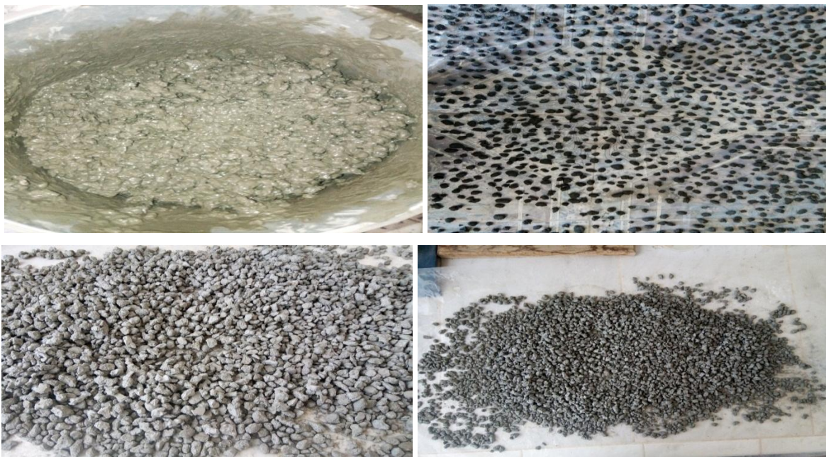
Gravier recyclé 8/16 après traitement.
