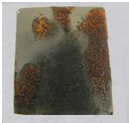
Figure IV.6 : Photo de l'acier P0 après t_{im} = 24 h; immersion dans NaCl 0,5 M à 25°C.
