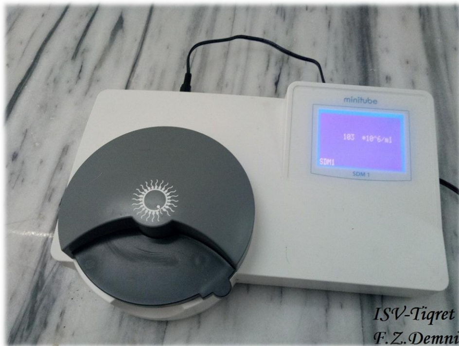
Figure 31 : La détermination de la concentration à l'aide d'un photomètre Minitube
