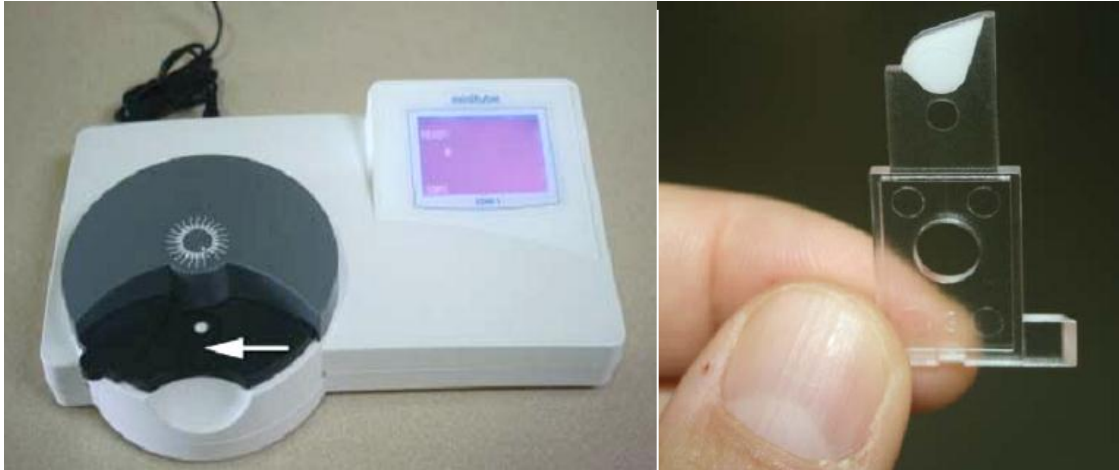
Figure 15 : photomètre Minitube avec cuvette remplie en sperme (John Dascanio. 2014).
