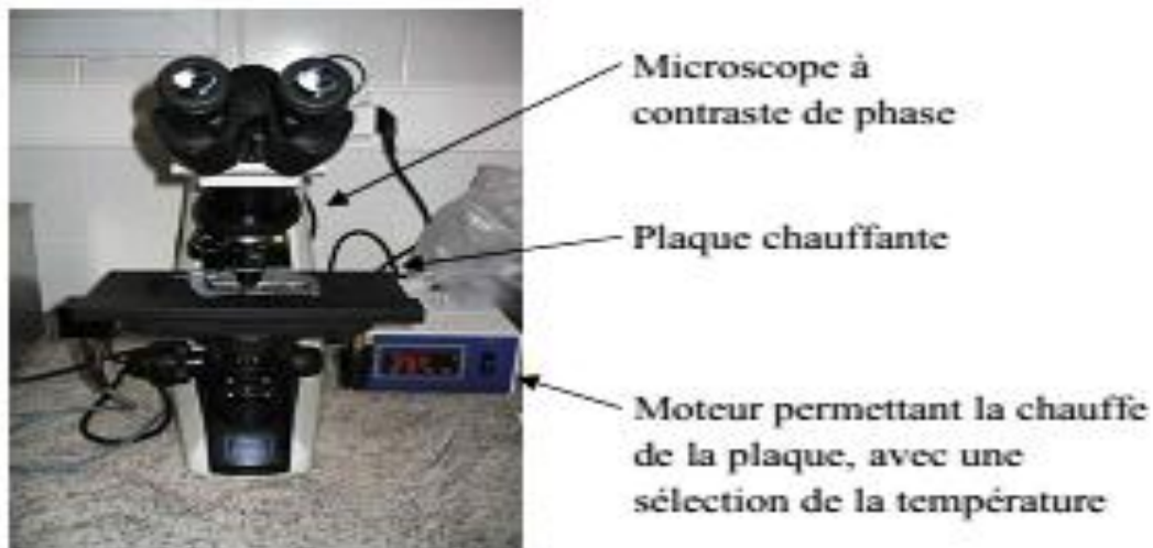
Figure 16 : microscope à contraste de phase muni d'une plaque chauffante (Marie Allimant, 2010.)
