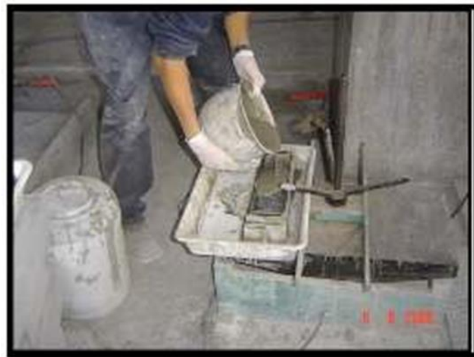
Figure I.3.3 : Infiltration de coulis aidée par des vibrations externes [24]
