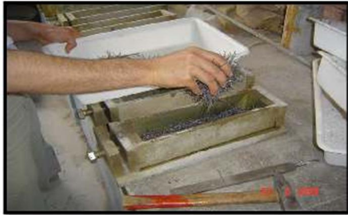
Figure I.3.2 : Placement à la main des fibres d'acier dans un moule [24]
