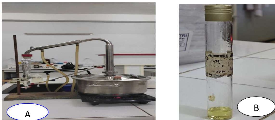
Figure N° 13: Hydro distillateur de type entraînement à la vapeur d'eau pour l'extraction de l'huile essentielle.
