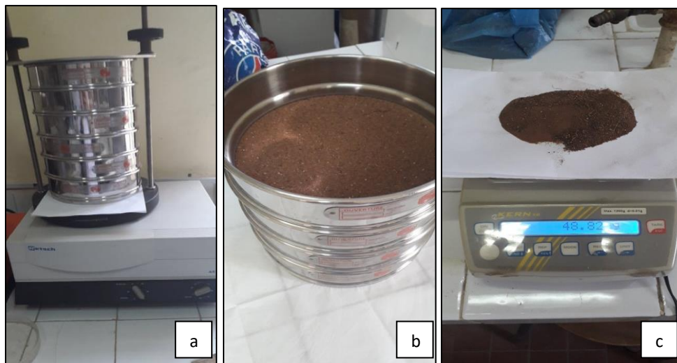
Fig.11 : Protocole de la granulométrie : a) tamisage 15 min. b) séparation des tamis. c) peser les granulats
