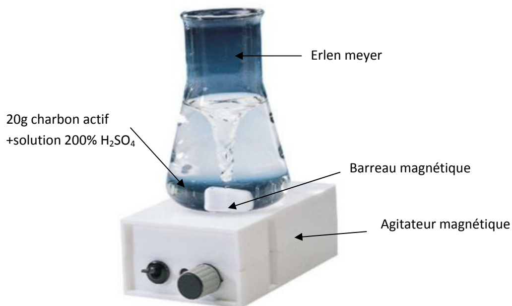
Figure 14. Montage expérimental de modification par H 2 SO 4 .
