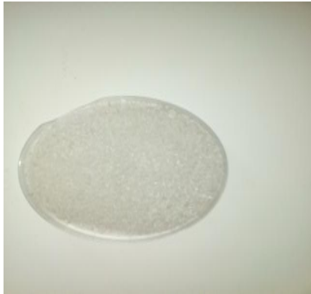
Figure 13 : Aspect du chitosane après désacétylation. NaOH à 50%.
