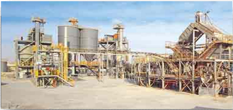
Figure IV.5 : Station de lavage du sable brut à l'unité ADWAN de Fornaka (Mostaganem)
