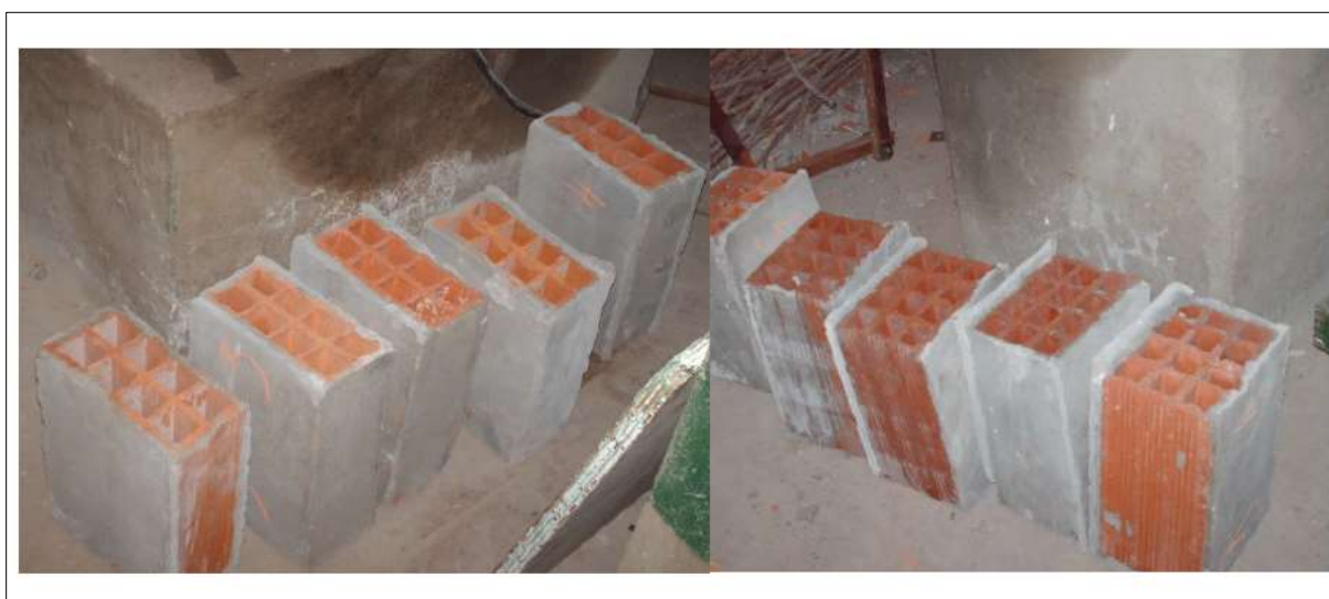
Figure III. 9. Brique creuse en terre cuite de 8 et 12 trous avec enduit en ciment
