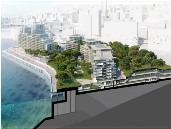
Figure 56 : Des caissons immergés pour Protéger le la future projet
