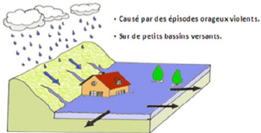
Figure 9. Inondation par ruissellement en secteur urbain.
