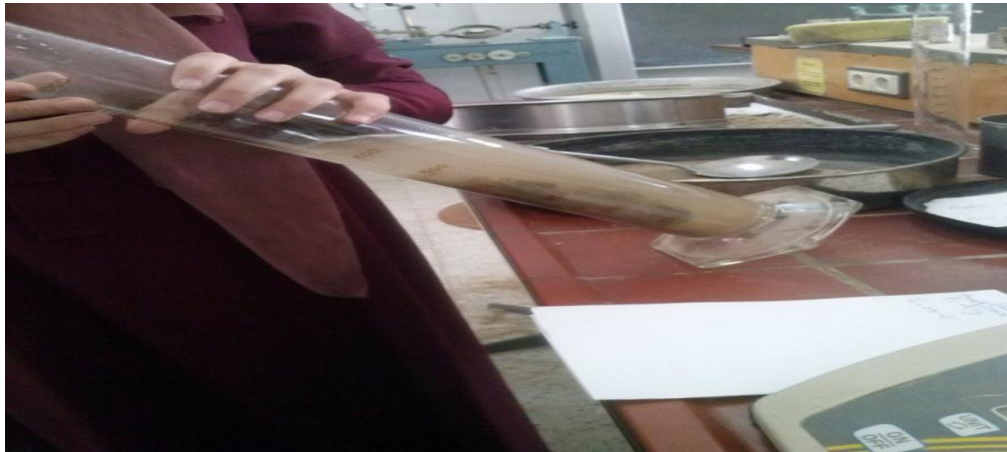
Figure II.9 : Mesure la masse volumique absolue des cailloux.
