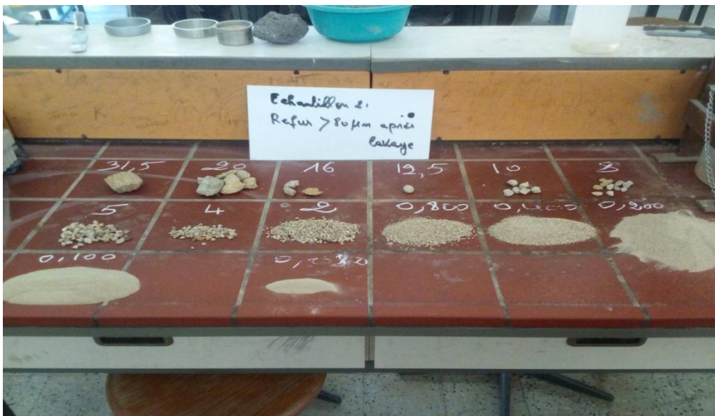
Figure II.4 : Refus des particules > 0.080 mm
