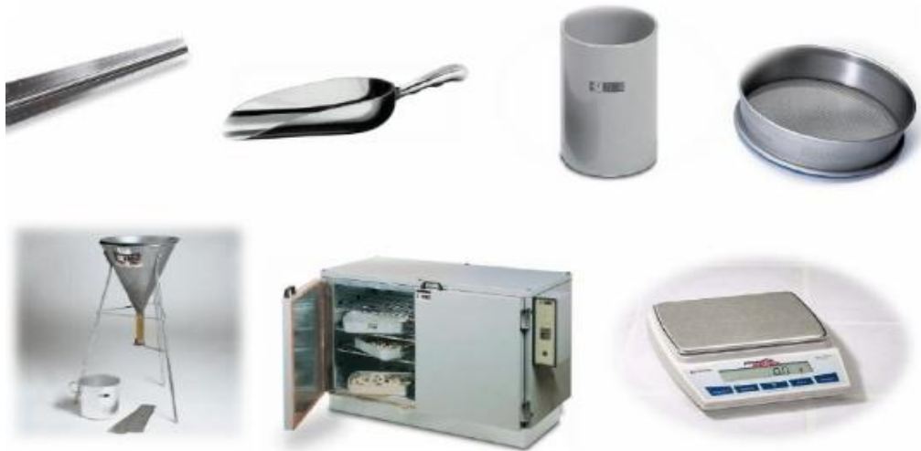
Figure II.6 : Matériels utilisés pour la mesure de la masse volumique apparente
