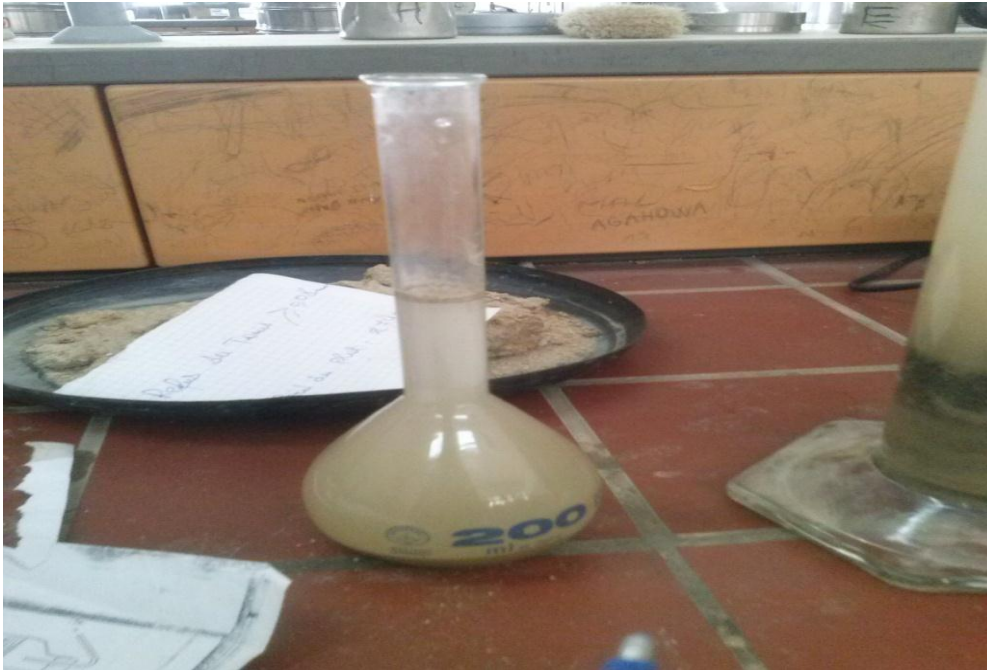
Figure II.10 : mesure la masse volumique absolue des fins.
