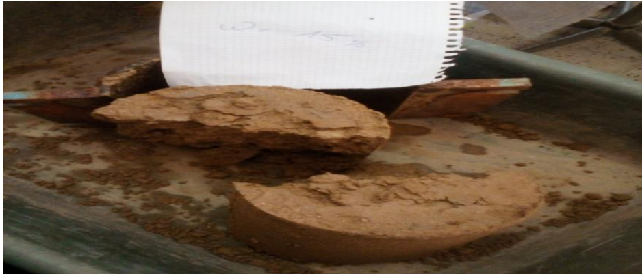
Figure II.22 : résultat d'essai proctor modifié ( \omega = 15\% ).
