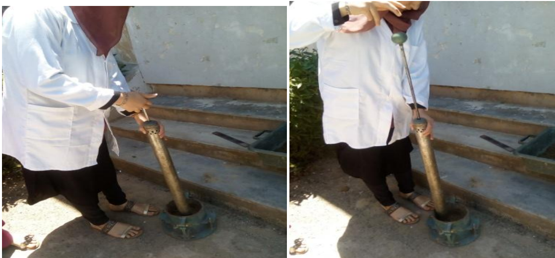
Figure II.20 : Mode opératoire de proctor.
