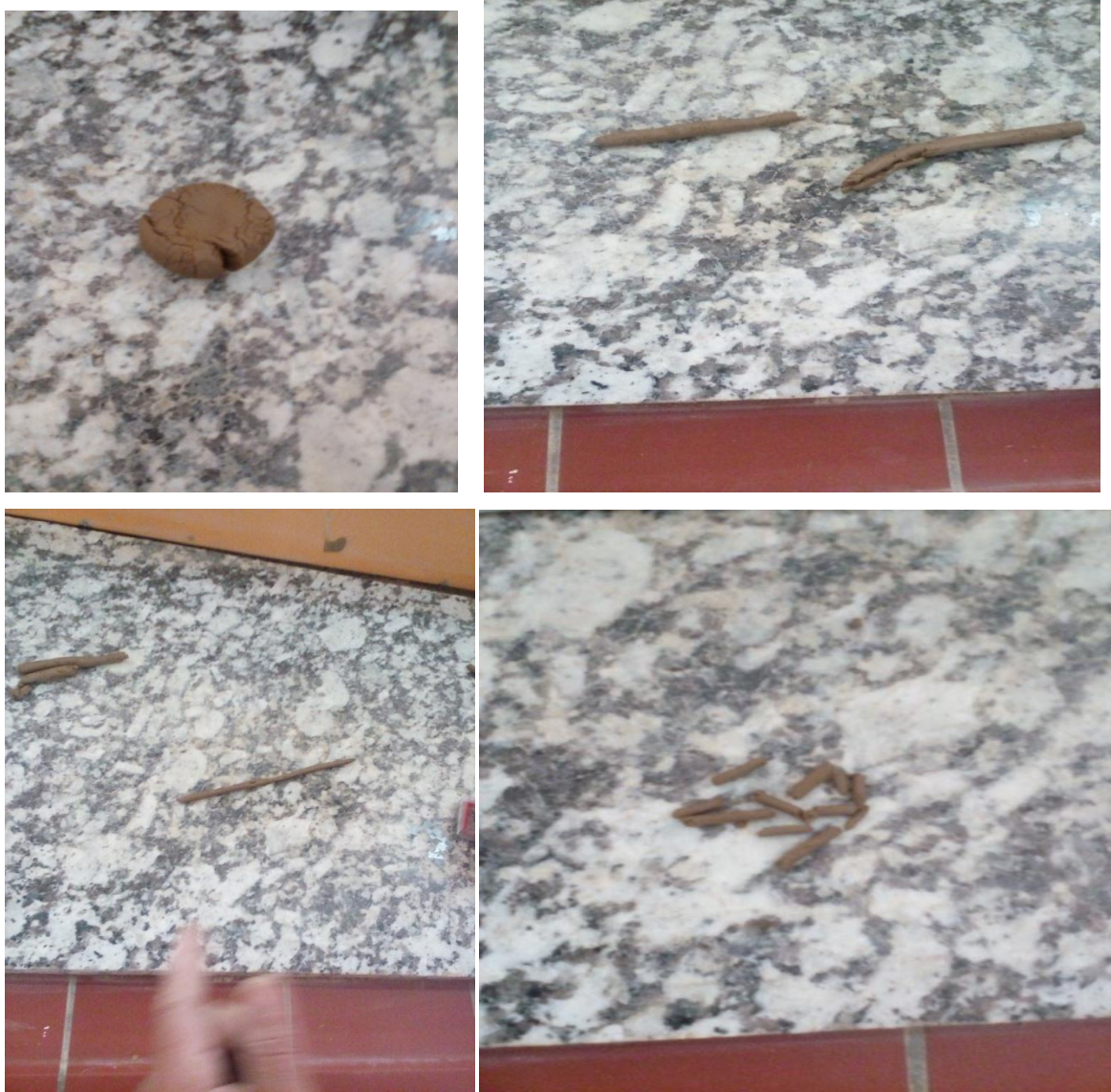
Figure II.17 : Mode opératoire du Limite de plasticité.
