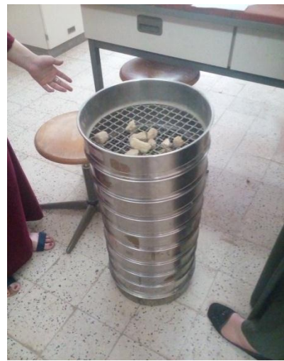
Figure II.2: série de tamis utilisée dans l'Analyses granulométrique.
