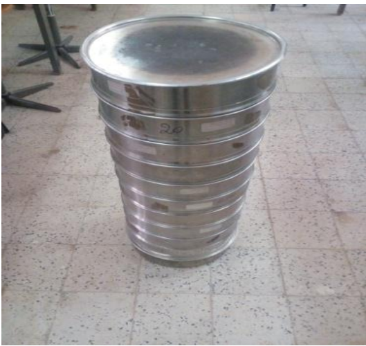
Figure II.2: série de tamis utilisée dans l'Analyses granulométrique.
