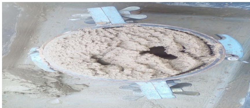
Figure II.23 : résultat d'essai proctor modifié ( \omega = 20\% ).
