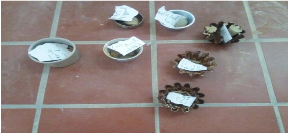
Figure II.21 : les différents échantillons prélevés pour calculer « W% ».
