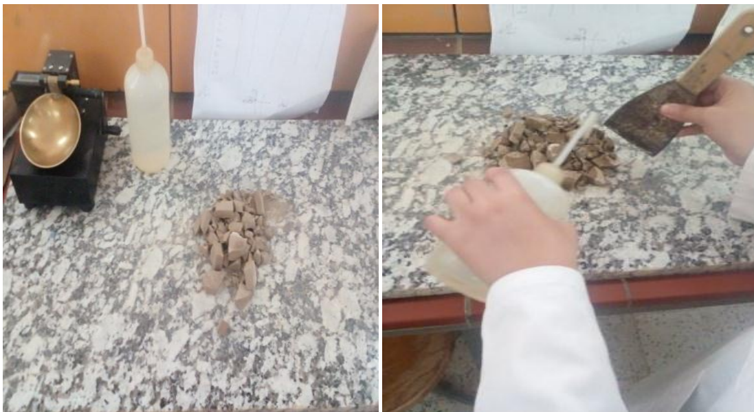
Figure II.15 : Mode opératoire du Limite de liquidité.
