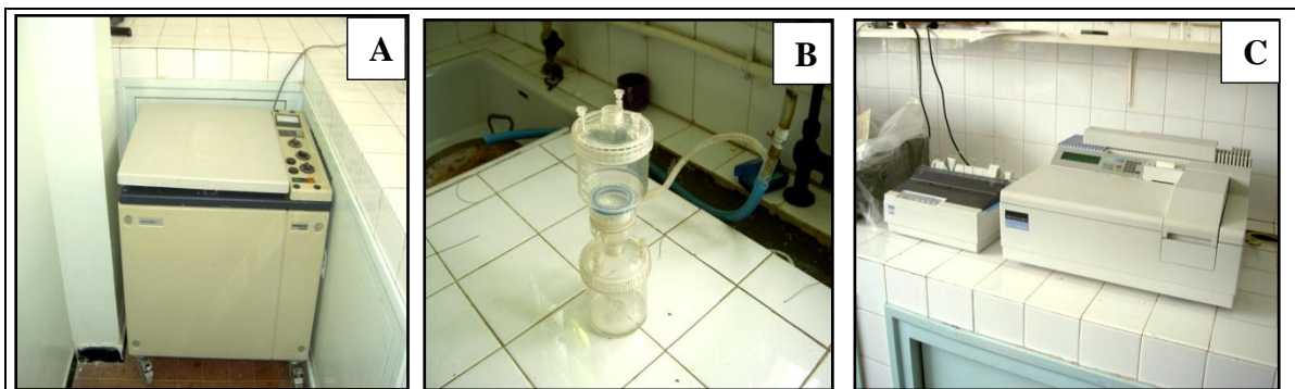
Figure 16: Méthode d'analyse de la chlorophylle (a) réalisé au laboratoire ANRH (Oran). A. centrifugeuse; B. appareil de filtration; C. spectrophotomètre.
