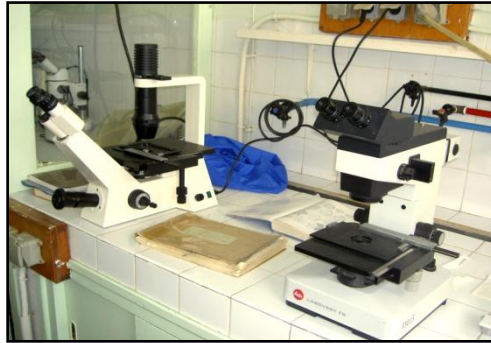
Figure 17 : Détermination des espèces phytoplanctonique à l'aide d'un microscope inversé au Gr. X 400 à gauche et au Gr. X 320 à droite, (présent travail réalisé à l'ANRH, Oran).
