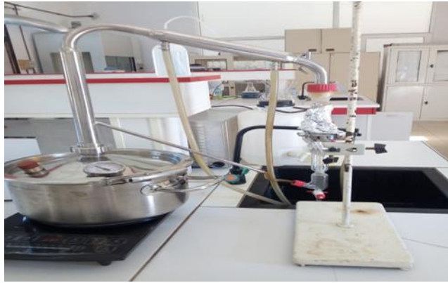
FIG12 : Dispositif d'extraction d'huile essentielle (mars 2019)
