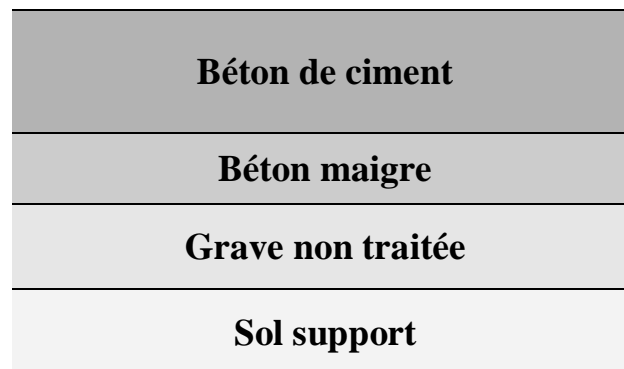
Figure I.3 : Corps de chaussée rigide
