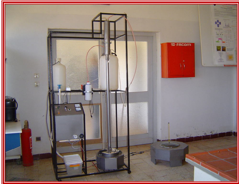
Figure 32. Appareil de distillation fractionnée réalisé au laboratoire.
