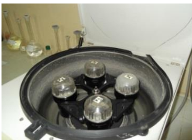
Photos 4 (c et d). Extraction des sels par Centrifugation et Filtration (Extrait saturé)
