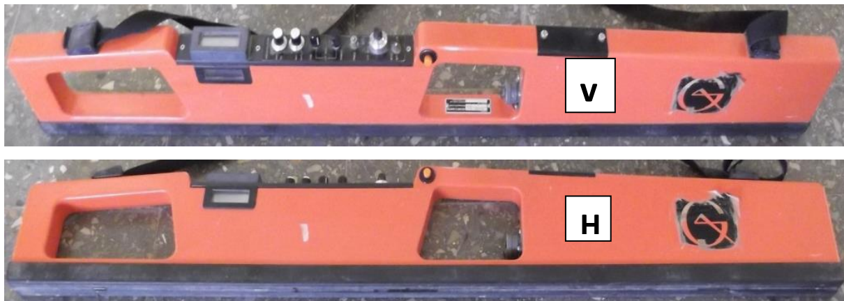
Figure 6. Conductivimètre électromagnétique EM-38 en mode vertical (V) et horizontal (H)
