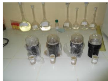
Photos 4 (c et d). Extraction des sels par Centrifugation et Filtration (Extrait saturé)
