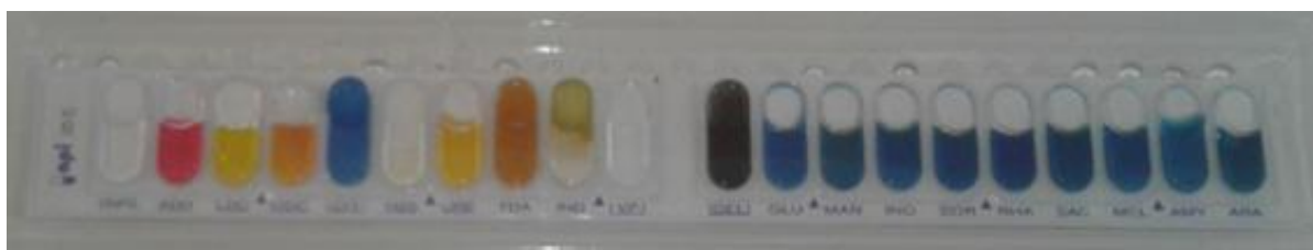
Figure 19 : La galerie biochimique API 20 E après une incubation à 37°C pendant 24h.
