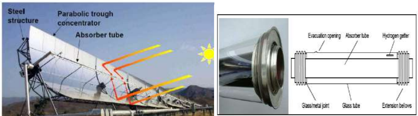
Figure I.5 : concentrateur cylindro-parabolique (gauche), et le tube absorbeur (à droite)
