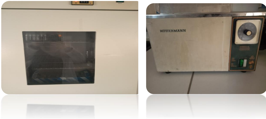
Figure 30 : incubé les échantillons à 37°C (à droite), chauffé les échantillons à 51°C (à gauche).
