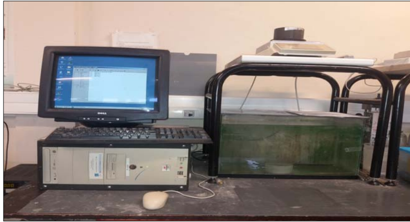
Figure II.17. Dispositif de la mesure en continue de la perte de masse
