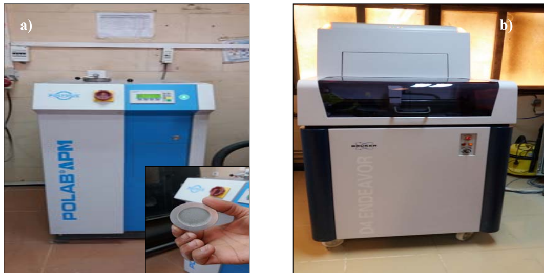
Figure II.7. a) Broyeur b) Diffractomètre de marque D4 ENDEAVOR
