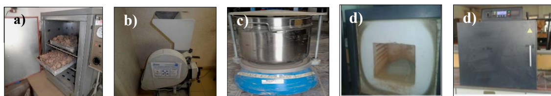
Figure I.5. a) séchage à 50°C b) concassage et broyage c) tamisage à 80µm d) calcination à 750°C pendant 5 heures
