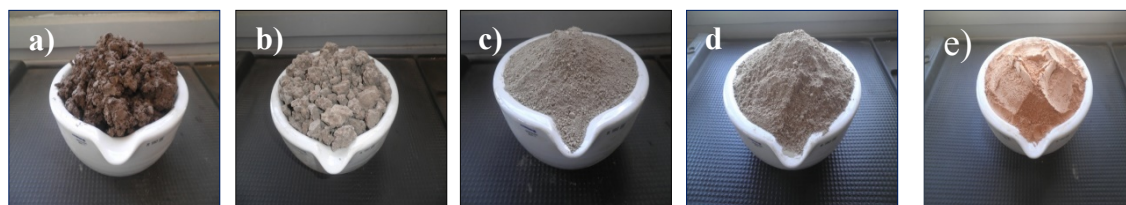
Figure I.6. a) vase brute b) vase séchée c) vase broyée d) vase tamisée e) vase calcinée
