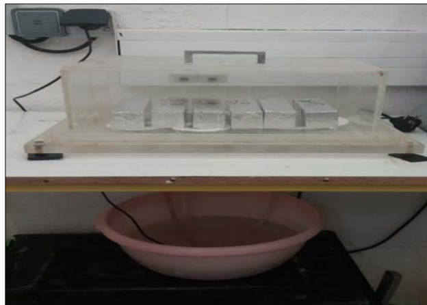
II.13. Dispositif expérimental pour l'essai d'absorption d'eau par capillarité
