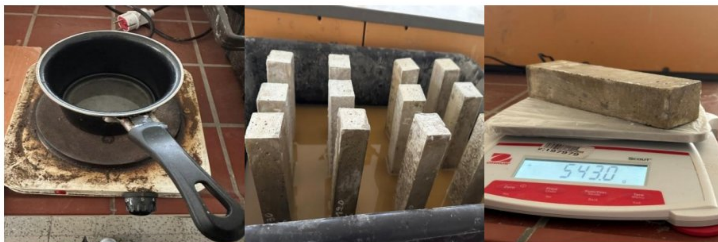
Figure III – 6: Essai de mesure de l'absorption capillaire unidirectionnelle
