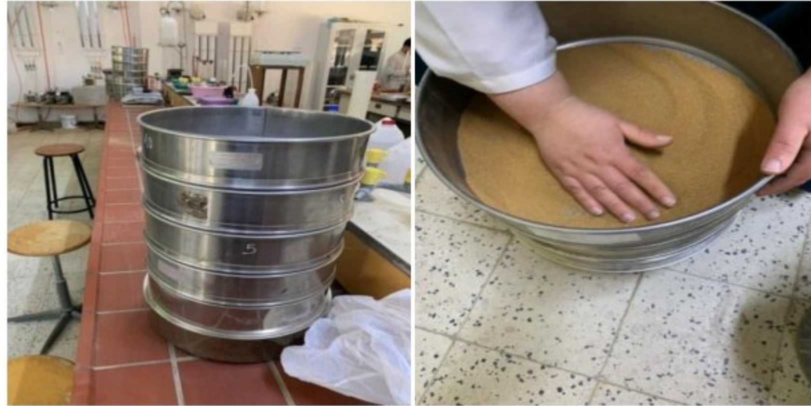
Figure II-6 : Essai de granulométrie de sable de mer
