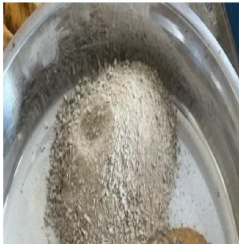
Figure II-5 : Sable de granulat recyclé (SGR)
